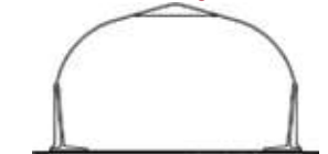
BEISPIEL Leichte "tunnelförmige" Stahlstruktur
