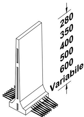
SEZIONE TIPO VASCHE FUORI TERRA - SEMINTERRATE - INTERRATE
