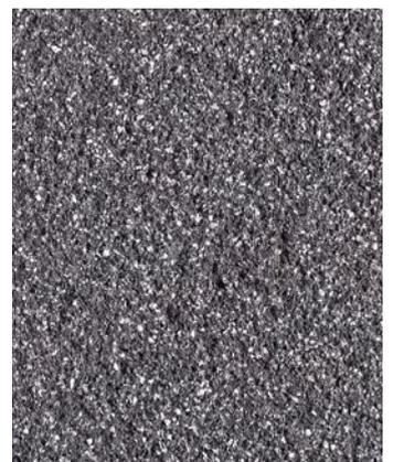
I colori dei Granitati sono la risultante di miscele d'inerti normali e graniglie colorate, pigmentati da ossidi, stabili nel tempo. Per mantenere costante il colore si usano materie prime provenienti sempre dalla stessa fonte, dosate con la massima precisione tramite un sistema informatico. Tale sistema gestisce anche il processo produttivo e rende affidabile la ripetizione dei risultati nel tempo.
