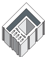
BLOCCO PX38 ANGOLO (SxHxL) 380x200x500 mm
